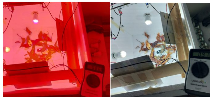
Figura 3.7: Medición de diferentes combinaciones de luz con el quantum. Fuente: Propia
